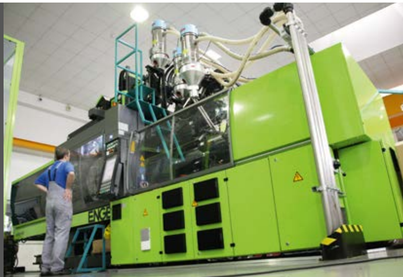
Dank Holmlostechnik passen vier Spritzeinheiten in kompakter Anordnung auf eine 400-Tonnen-Maschine.
