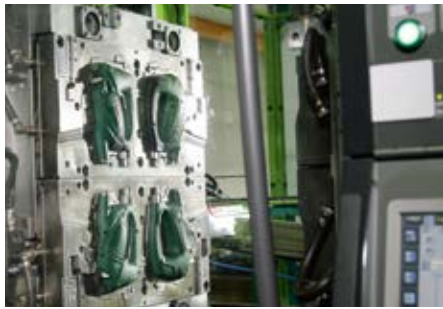
Die Aufspannplatten der holmlösen ENGEL victory Spritzgießmaschine wird bis an den Rand ausgenutzt.
